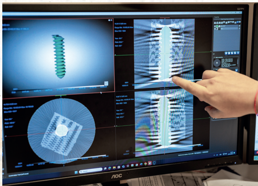
Porušený šroub analyzovaný pomocí rentgenové mikrotomografie
