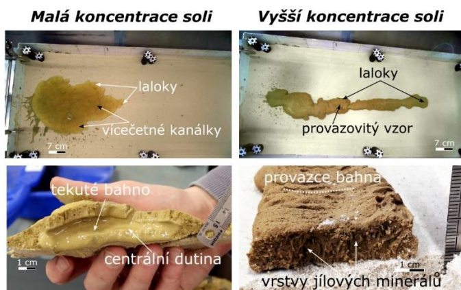
Obrázek 4: Ukázka některých tvarů bahenních proudů pro odlišné koncentrace soli (konkrétně se jedná o MgSO_4 a koncentrace 0,5 % a 10 %). S vyšším obsahem soli se zvyšuje dosah proudů, ale mění se i způsob toku a tvar proudů.
